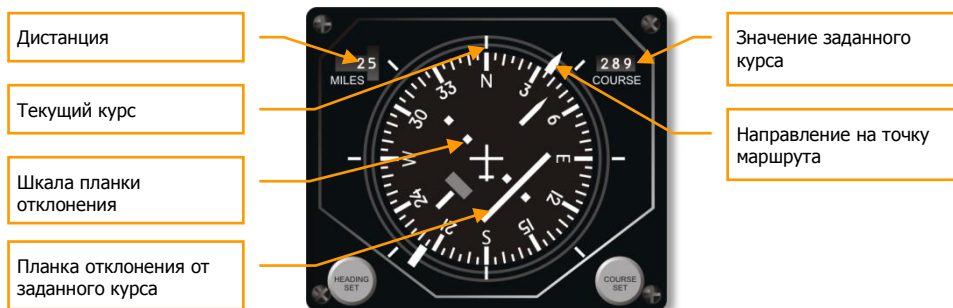
4-9: Индикатор горизонтальной обстановки (HSI)
