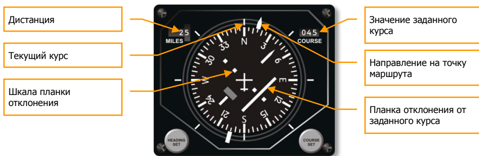
4-49: Индикатор горизонтальной обстановки (HSI)
