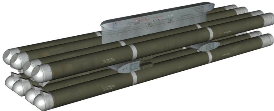
7-4: Авиацiонная пусковая установка АПУ-8 "Вихрь" (АТ-9)
