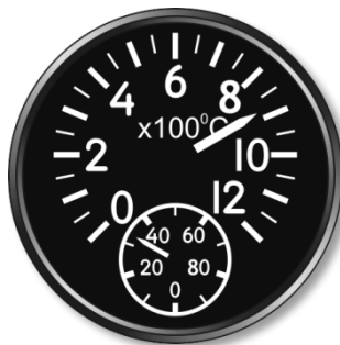
3-13: Индикатор температуры газов за турбиной
