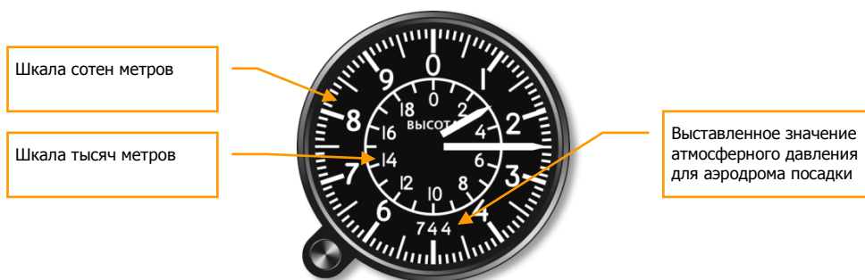
3-3: Барометрический высотомер
