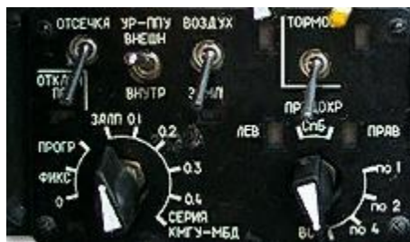
3-53: Щиток системы управления вооружением самолета Су-25Т
