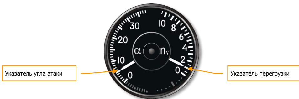
3-40: Указатель угла атаки и перегрузки
