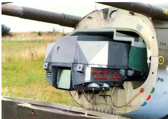
5-7: Лазерный дальномер-целеуказатель "Клен-ПС" на самолете Су-25
