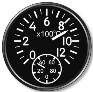
3-47: Индикатор температуры газов за турбиной
