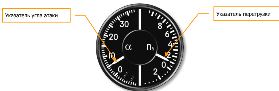
3-6: Указатель углов атаки и перегрузки
