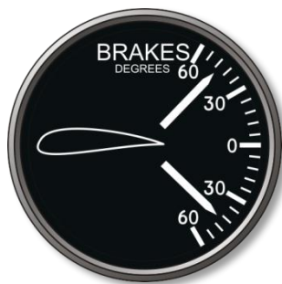
4-59: Указатель положения воздушных тормозов
